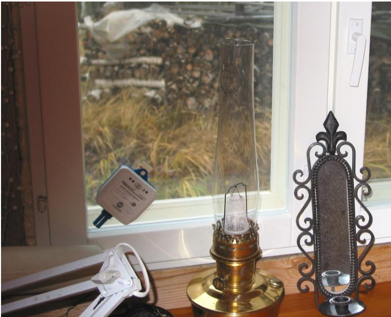
Kuva 3.3 Dataloggerin sijoittaminen ikkunapinnalle.
